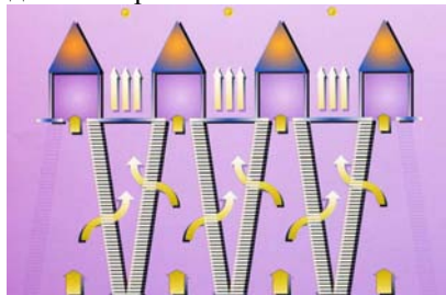
Рис. №6 Схема работы AAF AS. Проход воздуха через фильтры.
