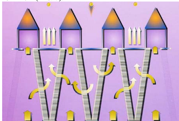
Рис. 8 Схема работы ВОУ AAF AS. Импульсная очистка фильтрующей панели.
